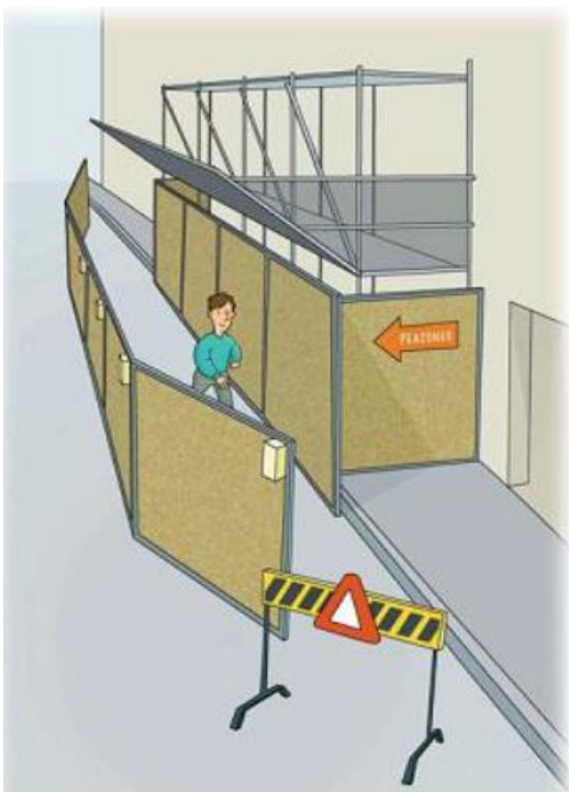
Imagen 14: Delimitación del área de trabajo. FUENTE: CÁMARA CHILENA DE LA CONSTRUCCIÓN. Manual de andamios. Comité de especializados.
